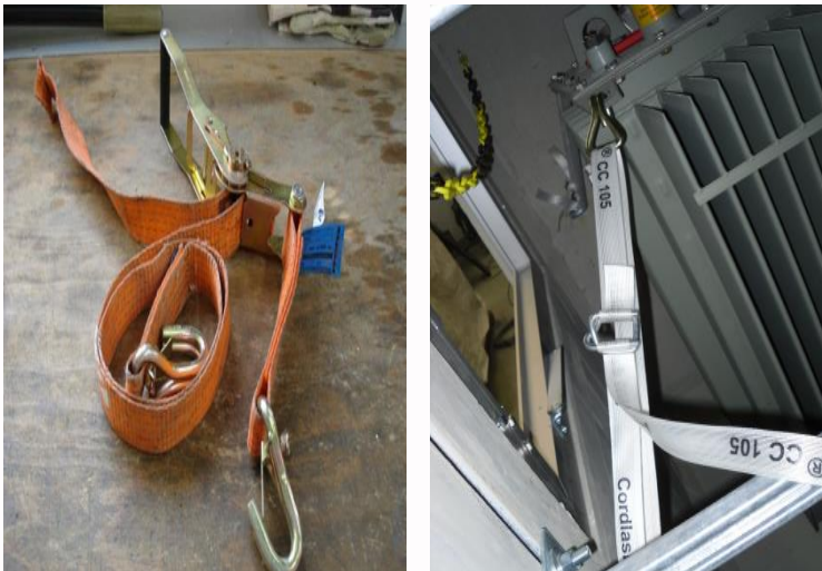
Abbildung 13: Beispiele für Ladungssicherung des Transformators in der ausgebauten Raumzelle
