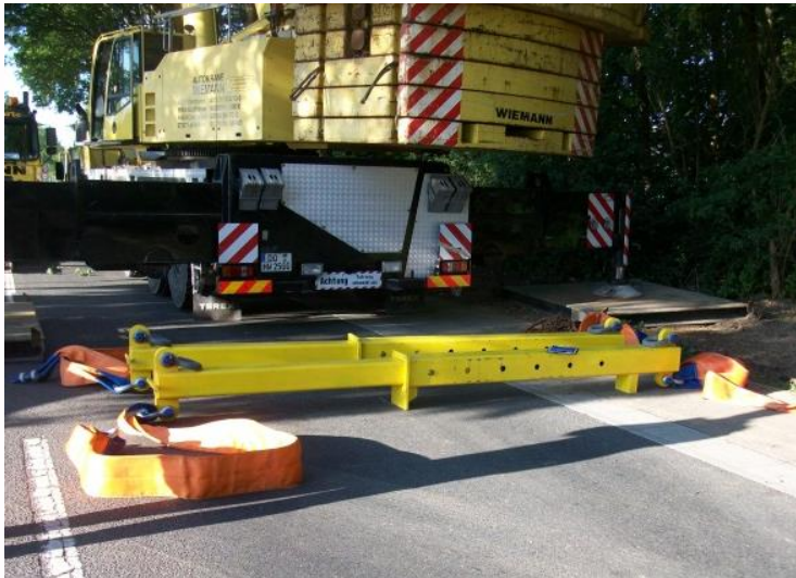
Abbildung 25: Traverse mit Kranaufhängern
