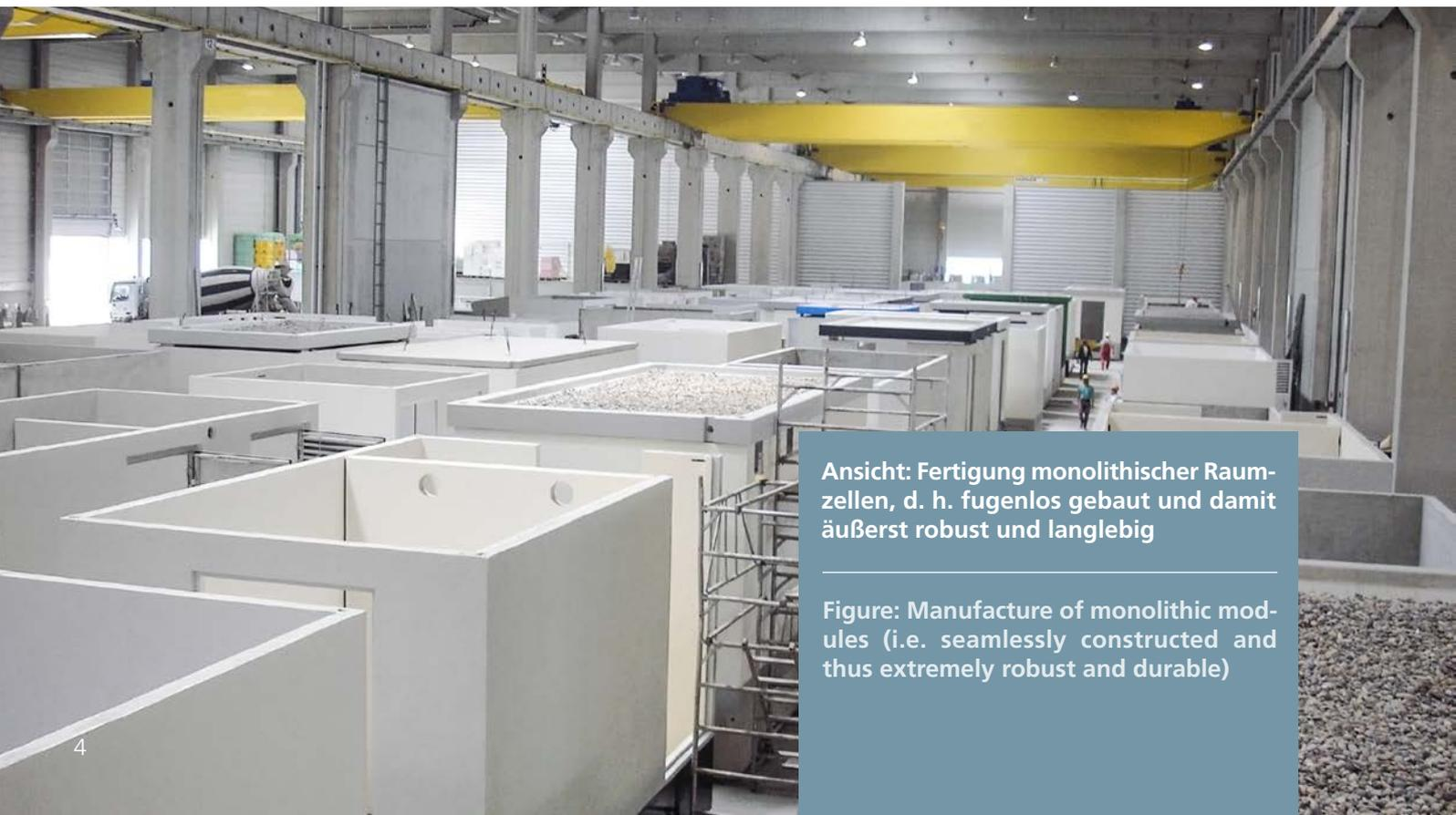
Ansicht: Fertigung monolithischer Raumzellen, d. h. fugenlos gebaut und damit äußerst robust und langlebig
